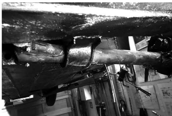
Obr. 10 – poloosa (polonáprava) kabrioletu má ale délku cca 620 mm
