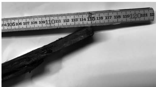
Obr. 8 – naměřená délka pera kabrioletu 115 mm
