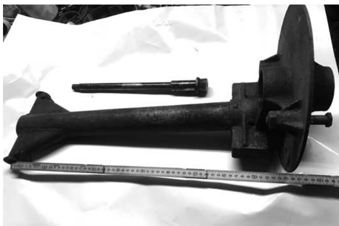
Obr. 9 – normální délka poloosy (polonápravy) je 556 mm.
